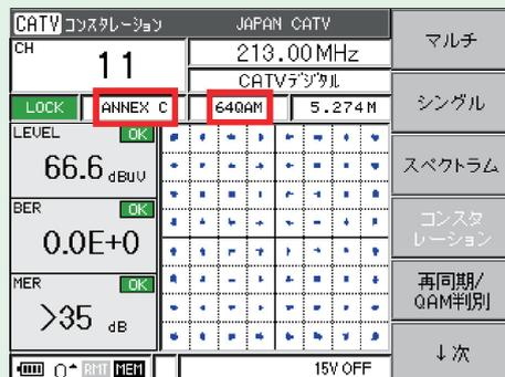
図1:64QAM信号をLF965で測定した例
