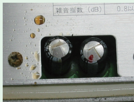
写真2:破損した電解コンデンサ
