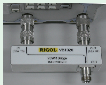
写真1: SWRを測定するためにVSWRブリッジをDSA800に接続した様子
