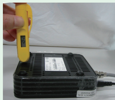
写真2:ケーブルモデムの温度測定
