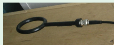
写真3: 近接磁界測定用ループアンテナ
