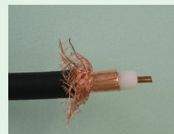
写真5:携帯基地局で使用される銅 фольテーパーを使った同軸
