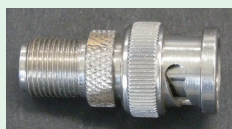
写真1:1G以上の高周波特性の悪い変換コネクタ
