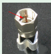
写真3: 心線が酸化したコネクタ
