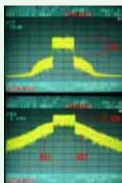
図1:過入力によりCNが悪化したOFDM信号
