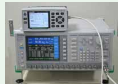
写真4: 入力出力レベルを測り、ゲインを計算する
