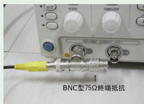
写真2:「DL1620」にて測定している様子
