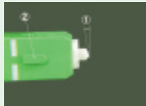
写真1: SCコネクタでAPC研磨の斜めに研磨された様子
