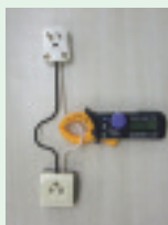
写真3: ジグでクランプ型電流測定器をセットした様子
