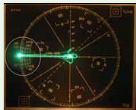
図3: ベクトルスコープで、DG=0%、DP=0度を示している様子
