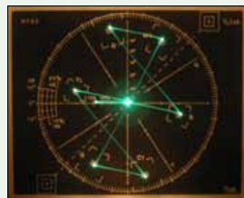
図5: カラーバー信号をベクトルスコープで見た様子
