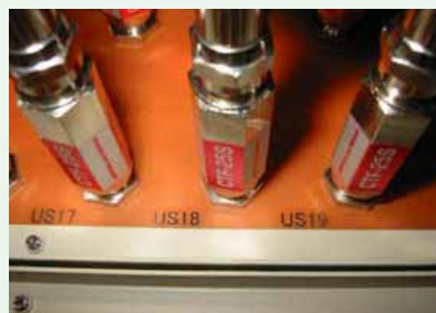
図4: HPF を直接装着できない場合の、中継端子盤に装着した様子
