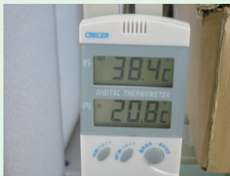
写真4:窓ガラス内側と室温
